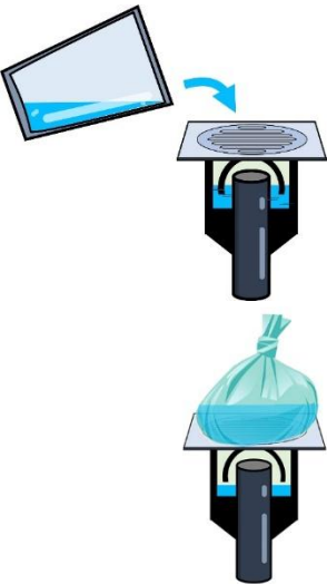
封闭水封装置
